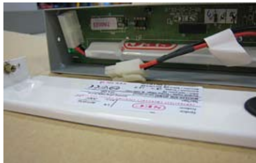
Batteriet kopplas in när snabbkopplingsklämmorna sätts samman.
